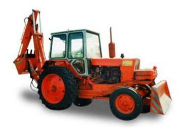
Экскаватор (ЭО 2621) одноковшовый с ковшом емкостью 0,25 м3 на базе трактора "Беларусь", модель ЭО-2621А предназначен для проведения и механизации земляных и погрузочных работ, может оснащаться двумя видами рабочего оборудования: основным - экскавационным и дополнительным - бульдозерным.
